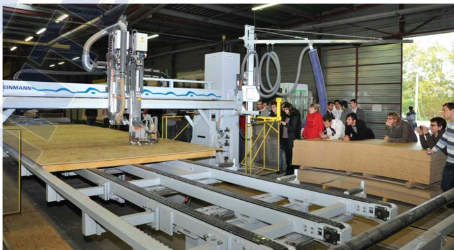
Dans l'usine Pobi, arrêt sur la chaîne Weinmann : les panneaux d'OSB sont agrafés sur les cadres des murs d'ossature.
